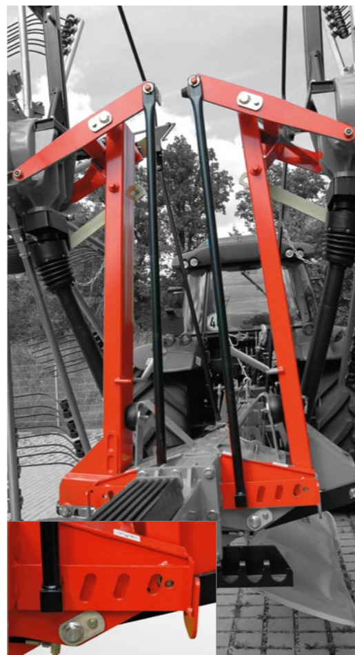
Regulacja szerokości roboczej / szerokości wału pokosu
