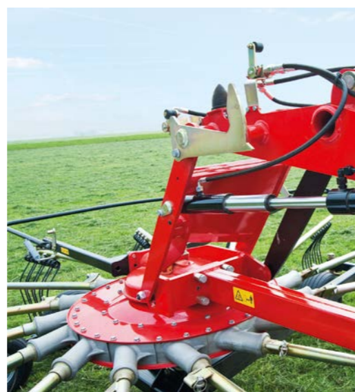
Hydrauliczna regulacja szerokości roboczej
