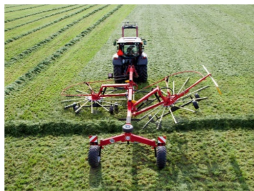
Układ sterowania nadążnego na końcu pola
