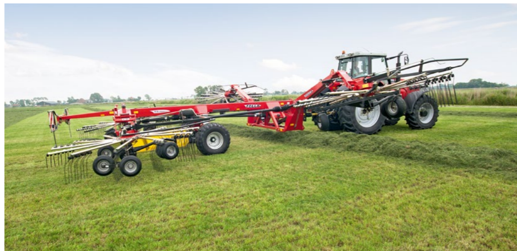
Automatyczne hydrauliczne sterowanie nadążne
